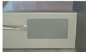
Avec un tournevis étoile, soulevez la partie cachant le mécanisme pour le débarrer (**1 et 2**).
